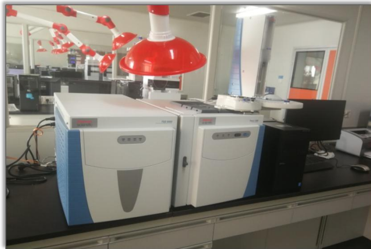
美国赛默飞 Thermo Fisher Scientific TSQ 9000 三重四级杆气质联用仪
