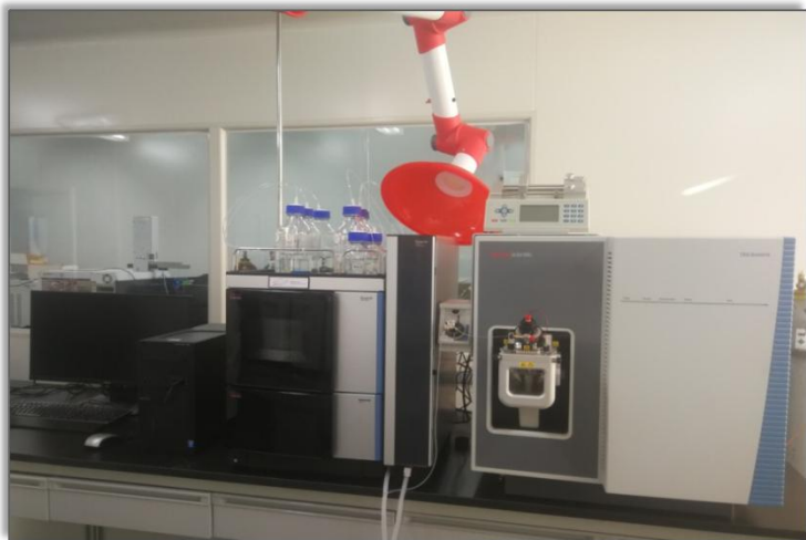
美国赛默飞 Thermo Fisher Scientific TSQ Quantis 三重四级杆液质联用仪
